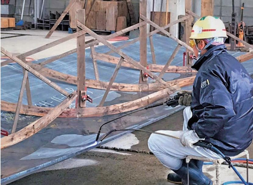
5～6万トン、時には数10万トン級の外航貨物船の、ボディを始めとした随所に使われる鋼材の加工を行っている当社。6万6,000平米の広大な工場敷地には、大型設備投資による幅17.5mもの大きな鋼板を2,000トンの圧力で一気に加工できる超大型シップベンダー2機や、タワークレーン、マグネットクレーンなどの設備が充実しています。
